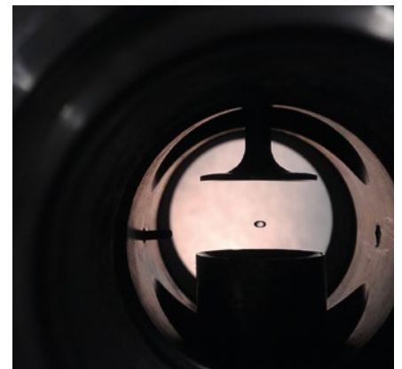
Akustisch levitierter Tropfen Bild: BOROSA Acoustic Levitation GmbH
