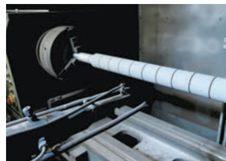
Beschichtung eines Werkstücks mit dem Außen-Spritz-Brenner für höchste Kundenansprüche
